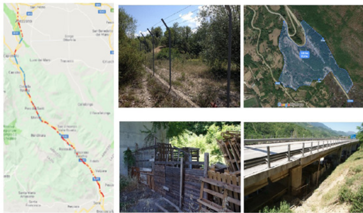
Figura 5. Lato sinistro: localizzazioni di ponti (in rosso) e di gallerie (in blu) lungo la Strada Statale 690. Lato destro: tipi diversi di infrastrutture che impediscono la percorribilità di sottopassi e sovrappassi.
